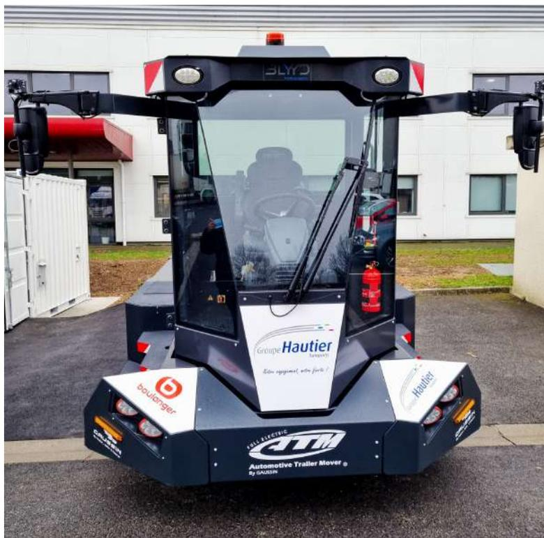
Le tracteur « zéro émission » est animé par deux batteries électriques de 55 kW et permet de déplacer, à l'intérieur du parc logistique, des semi-remorques allant jusqu'à 44 tonnes.
